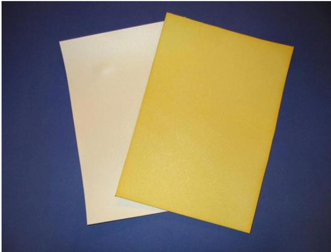
PU泡棉基材在紫外线(日光)
